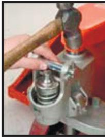
2 Установите вал ручки в соответствующие отверстия, и используя молоток, установите пружинный штифт только с одной стороны.
