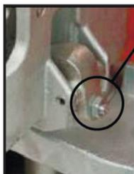
Используйте соответствующий зажимной винт и контргайку для регулировки, они расположены со стороны насоса. Данная конструкция облегчает регулировку ручной тележки. Необходимые инструменты: плоская отвертка и гаечный ключ 14 мм
