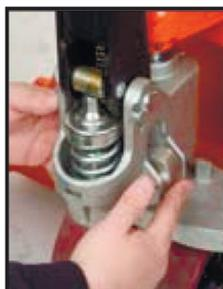
10 Используя обе руки нажмите на кулачок клапана, чтобы поднять крюк внутри корпуса, и проденьте конец цепи в кулачок (см. фото справа).
