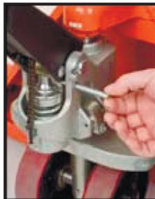
8 Проденьте цепь и гайку **ЧЕРЕЗ** центральное отверстие вала рукоятки сначала обратно внутрь рукоятки.
