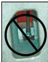
Не регулируйте рычаг подъема/ опускания с помощью контргайки на конце цепи ручки. Если фиксирующая резьба из нейлона будет удалена с резьбы винта, то вибрация от перевозки приведет к раскручиванию гайки и ее выпадению, что сделает рычаг непригодным для использования.
