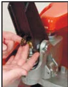
7 Опустите рукоятку, чтобы снять натяжение предохранительного штифта. **ОСТОРОЖНО** выньте предохранительный штифт.
