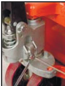
11 Прокачайте рычаг несколько раз для подъема вил. Установите рычаг подъема/опускания в **НЕЙТРАЛЬНОЕ** положение. Используя 14 мм гаечный ключ и плоскую отвертку, отрегулируйте кулачок клапана так, чтобы вилы на опускались или поднимались (если ручка нажата) в данном положении.
